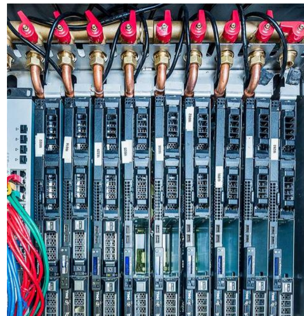
Fig. 3 - Un exemple de « chaudière numérique » Stimergy. Les serveurs sont immergés dans un bain d'huile qui permet de récupérer la chaleur émise pour produire de l'eau chaude utilisable dans le bâtiment. Crédit : Samuel Moraud
